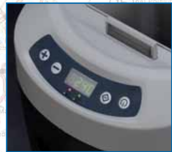
Termostato elettronico con lettura della temperatura a display (a LCD bianchi).
